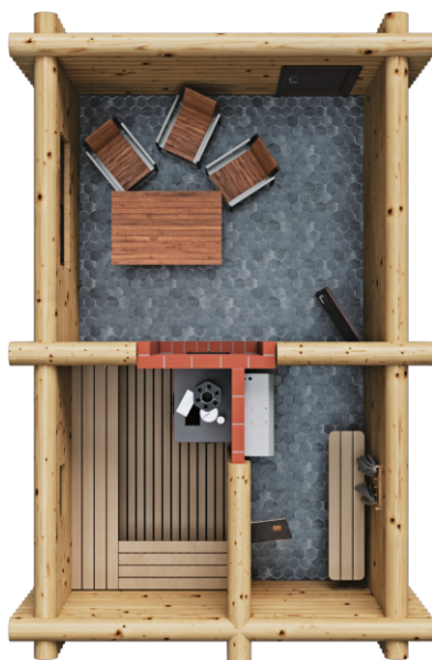
Рис. 9 Пример установки печи в кирпичном кожухе с функцией обогрева комнаты отдыха и моечного отделения
